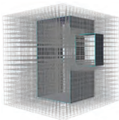
Рисунок 4 – Расчетная сетка конечных элементов по модели ленточного регулятора
