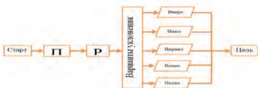
Рисунок 1. Система уклонения от препятствия для варианта «Препятствие спереди»
