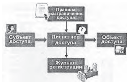
Рис. 1. Схема работы механизма разграничения доступа
