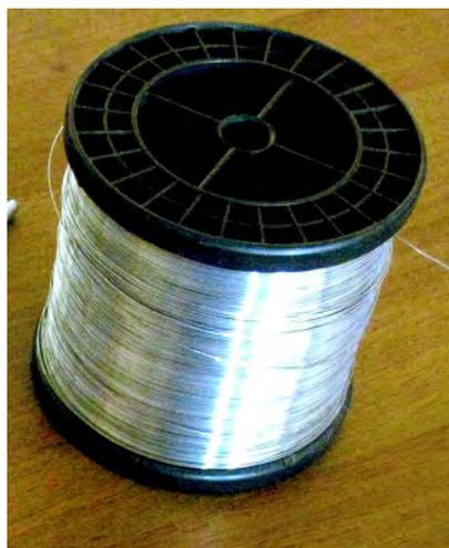
Рис. 2. Изготовленная алюминиевая проволока
