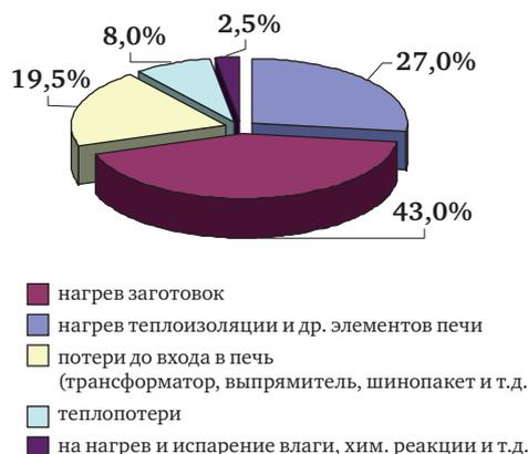
Рис. 11. Расходные статьи теоретического результирующего теплового баланса печи Ачесона
