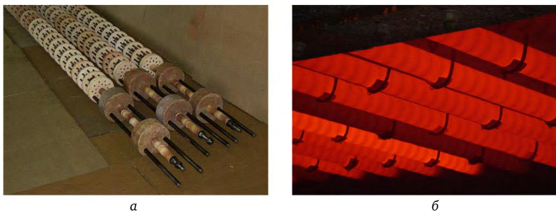
Рис. 3. Трубчатые нагревательные элементы конструкции ООО «НПЦ Магнитной гидродинамики» для миксеров САМП-100: *а* – общий вид; *б* – в ходе эксплуатации
