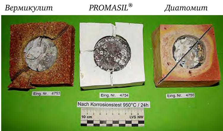
Рис. 1. Испытания образцов в тигле при температуре 950 °С в течение 24 ч
