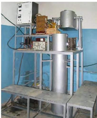
Рис. 1. Лабораторная установка для получения алюминиевого прутка и проволоки в электромагнитном кристаллизаторе
