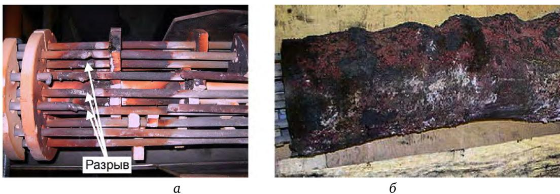
Рис. 1. Эксплуатационные дефекты электронагревателя после 6 месяцев эксплуатации: *а* – нагревательного элемента Kanthal Tubothal; *б* – защитной трубы Kanthal APM
