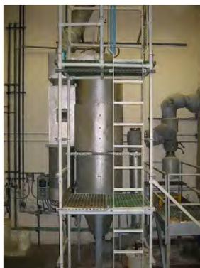
Рис. 12. Гидролизер с распылением для раствора хлорида титанила
