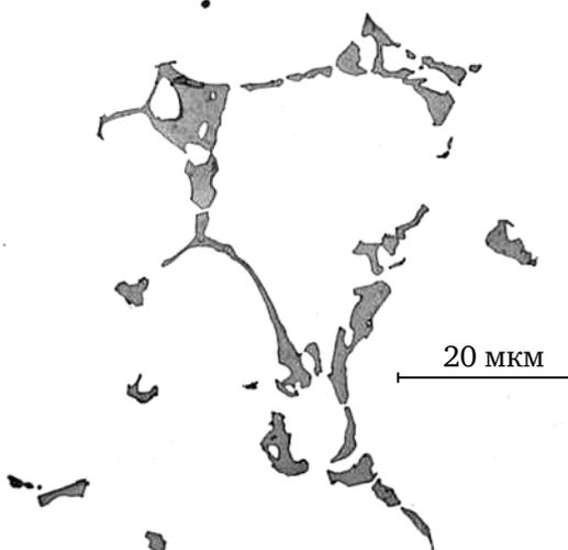
Рис. 4. Микроструктура  $\alpha_{Al}$ -твердого раствора слитка сплава Al–Sc. Средний размер зерен около 41 мкм
