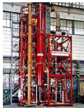
Рис. 13. Дистилляция при переменном давлении для восстановления  $HCl$
