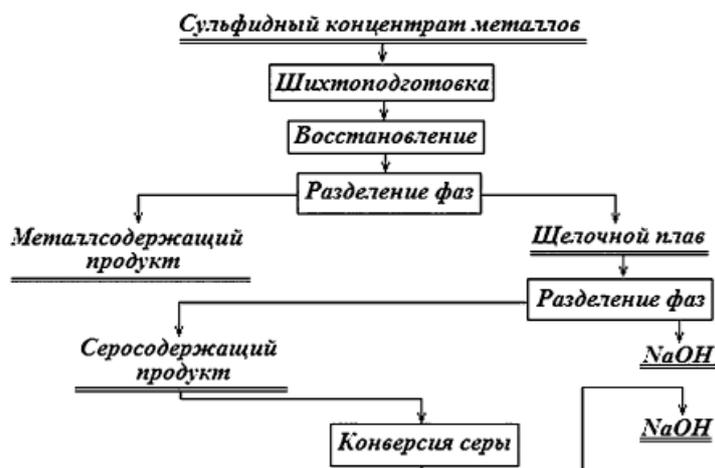
Рис. 1. Блок-схема технологического процесса восстановления металлов из сульфидных соединений
