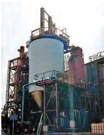
Рис. 17. Установка регенерации соляной кислоты в процессе производства искусственного рутила с применением сушильной печи с распылением
