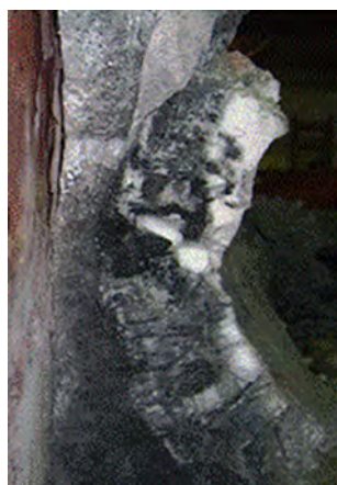
Рис. 1. Проникновение расплава в бортовые \text{SiC-Si}_3\text{N}_4 -плиты выходной стороны
