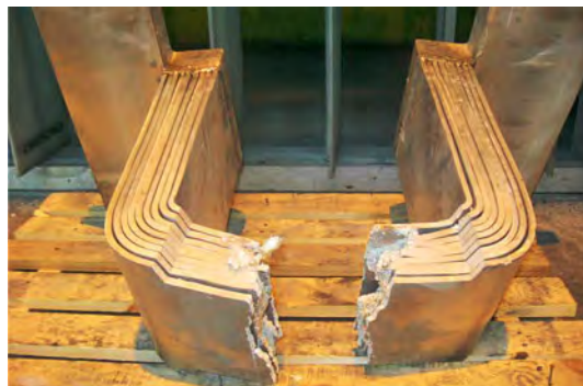
Рис. 7. Отработанная П-образная плавкая вставка
