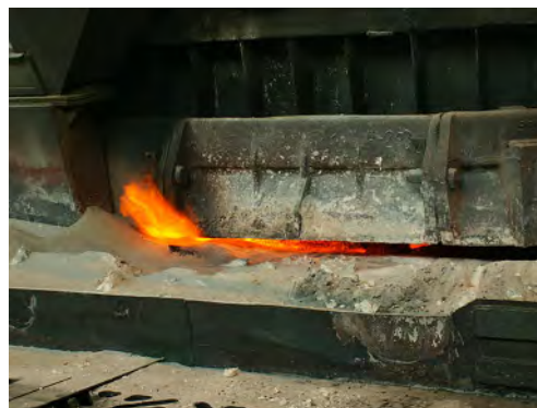
Рис. 7. Горение анодных газов в подколокольном пространстве при разгерметизации ГСК
