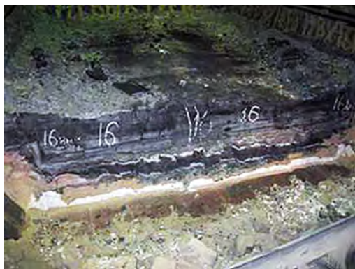
Рис. 4. Поперечное сечение катодного устройства
