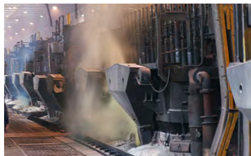
Рис. 6. Выбивание пыли и газов из-под мундштуков АПГ в момент загрузки в электролизер порции
