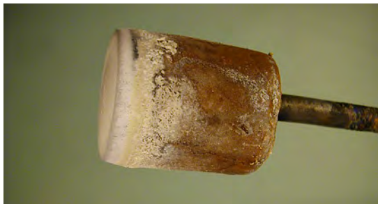
Рис. 4. Кермет, состава NiFe 2 O 4 ; 18% NiO; 17% Cu; частицы Cu < 10 мкм после 8 час. электролиза
