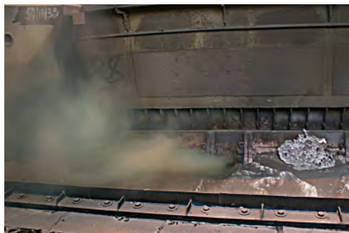
Рис. 2. Выбивание анодных газов в атмосферу корпуса при забивании подкололольного пространства оплесами
