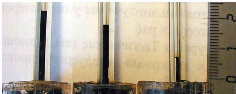
Рис. 5. Экспериментальные ячейки с пеком, заполнившим капилляры
