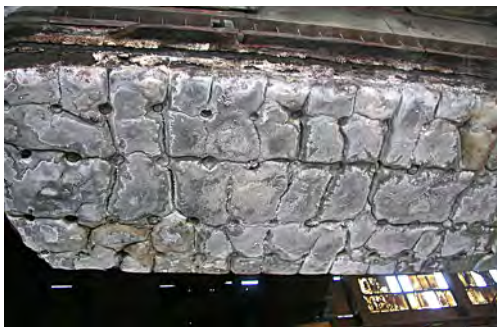
Рис. 1. Состояние подошвы анода в условиях его эксплуатации на повышенной силе и плотности тока
