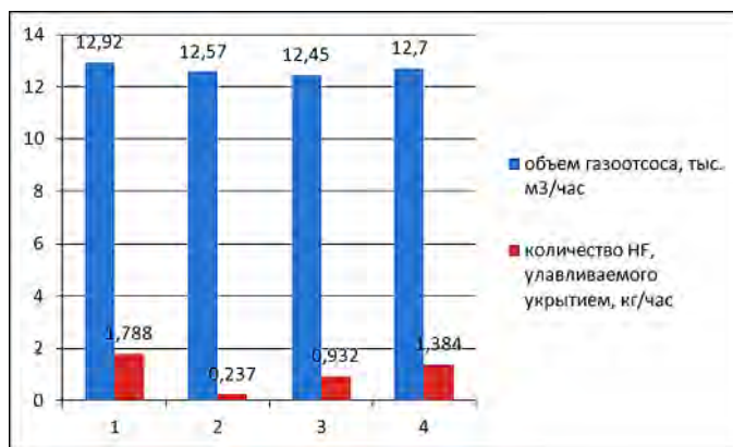
Рис. 3. Зависимость средних объемов газоотсоса (м 3 /ч) от состояния укрытий: 1 – створки закрыты; 2 – открыты две створки с одной стороны электролизера; 3 – открыты четыре створки (по две с каждой стороны электролизера); 4 – открыт торцевой щит (выливка)
