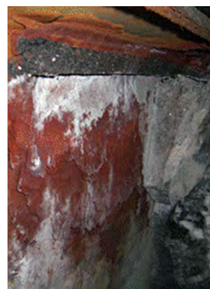
Рис. 2. Разрушение боковой стороны отключенного электролизера: а – выработка боковой футеровки; б – слой окалины на внутренней стенке стального кожуха
