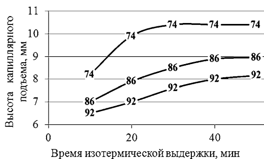
Рис. 6. Динамика подъема пеков с разными температурами размягчения (цифры у кривых) по капиллярам диаметром 0,56 мм при температуре 150 °С
