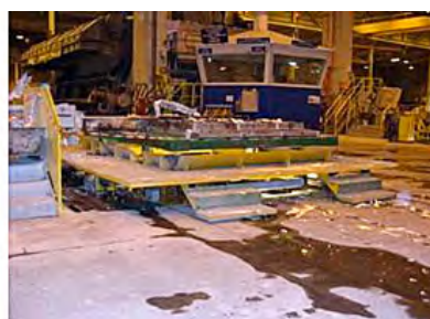
Рис. 8. Взрыв воды/расплавленного металла в литейном отделении в Туа, 2003 г. Литейный стол со слитками упал в литейную яму
