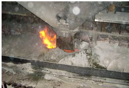
Рис. 4. Характер обвалов корки вокруг мундштука бункера АПГ
