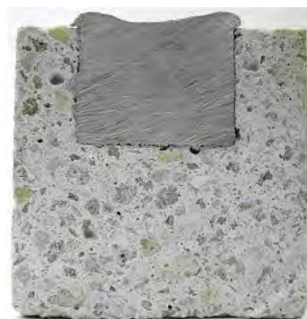
Рис. 2. Смачивание расплавом алюминия бетона с уплотненной структурой без использования несмачивающей добавки
