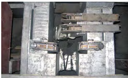
Рис. 3. Плавкие вставки № 3 (П-обр.) и № 4 (S-обр.)
