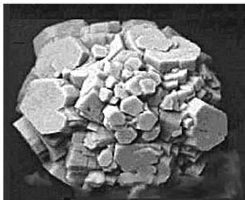
Рис. 8. Карбонизационный глинозем; прочность 19 ед.
