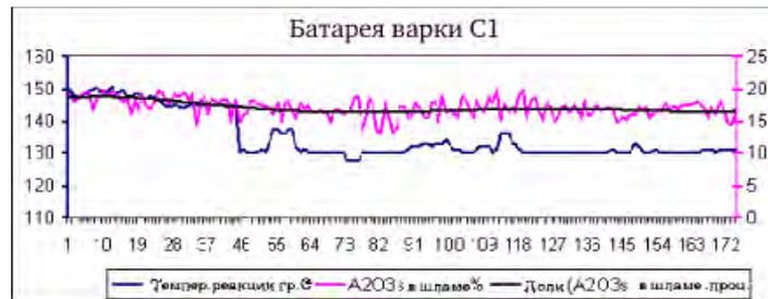
Рис. 4. Глинозём в шламе в сопоставлении с температурой варки на линии варки №С1
