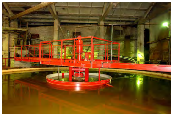
Рис. 2. Модернизация радиального сгустителя с периферийным приводом на ДОФ «Оловокомбинат» г. Новосибирск
