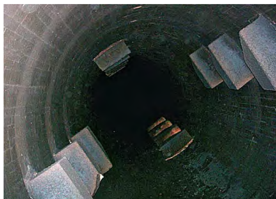
Рис. 3. Вращающаяся печь с установленными столбчатыми порогами (две панели по два ряда на каждой)
