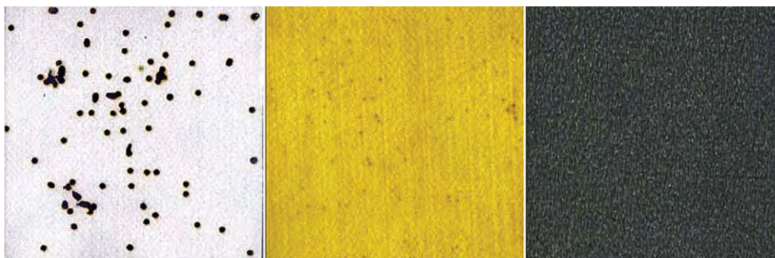
Рис. 6. Влияние стальных раскаленных шаров на разные волокна
