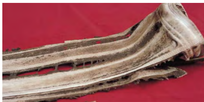
Рис. 4. Полимерный фильтровальный рукав, частично сгоревший в процессе работы
