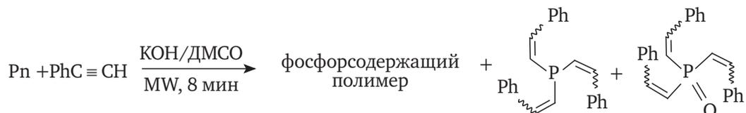
Фосфорсодержащий полимер состава  $(\text{C}_{25}\text{H}_{30}\text{O}_5\text{P}_2)_n$ , выделяют из подкисленных водных растворов (до pH 4,5–5) экстракцией хлороформом и удалением последнего при уменьшенном давлении.
