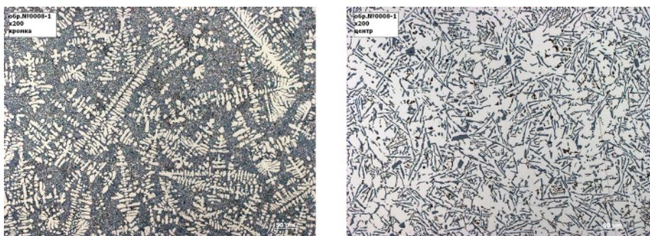
Рис. 2. Структура сплава Al – 12%Si, x200
