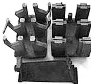
Рис. 2. Лом деталей из жаропрочного никелевого сплава ЖС-32
