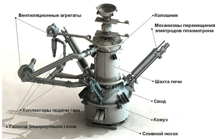
Рис. 1. Общий вид плазменной шахтной печи для технологии «EPOS-process»
