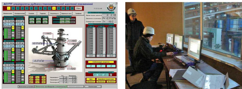
Рис. 5. Мнемосхема САУ на экране управления и пульт управления РШПП-1,5
