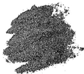
Рис. 1. Ренийсодержащие отходы полирования изделий из жаропрочных никелевых сплавов
