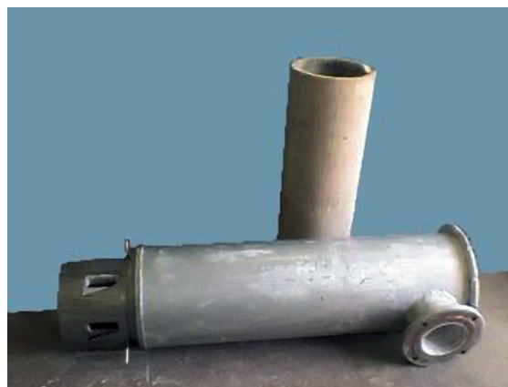
Рис. 8. Внешний вид теплоизолированной горелки
