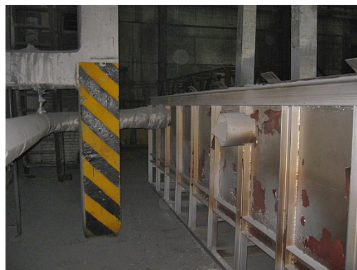
Рис. 2. Задняя стенка контейнера охлаждения анодных огарков с газоотводящим патрубком
