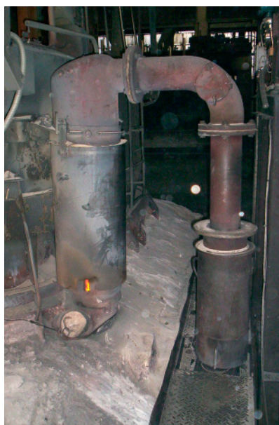
Рис. 3. Щелевая горелка с экраном на электролизной ванне
