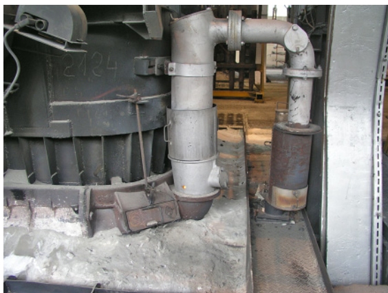
Рис. 5. Горелочное устройство с противоточным теплообменником на электролизной ванне
