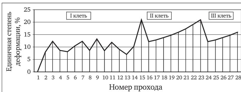
Рис. 1. Зависимость единичной степени деформации  $\epsilon_{ед}$  от номера прохода
