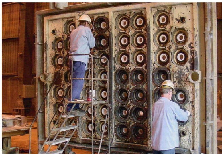
Рис. 2. Обслуживание рабочей поверхности. Обратите внимание на поврежденную поверхность защитного покрытия литейной ямы (белый)
