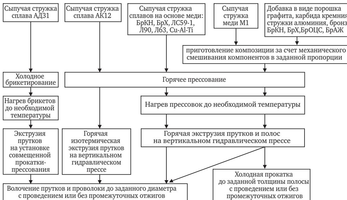
Рис. 2. Технологические схемы получения изделий из стружковых материалов, апробированные на кафедре ОМД ИЦМиМ СФУ
