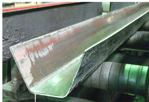
Рис. 2. Внешний вид гнутого профиля размерами 150×180×300×8 мм
