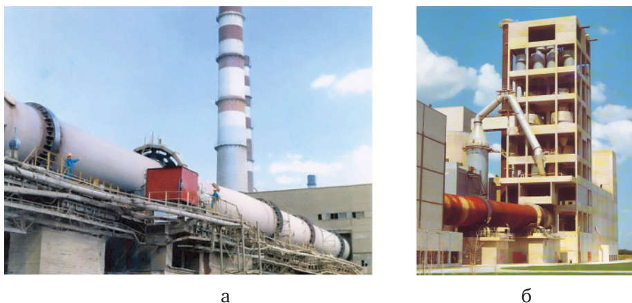
Рис. 1. Внешний вид установок мокрого и сухого способа: а – мокрый способ производства, печь \varnothing 4 \times 150 м; б – сухой способ производства; печь \varnothing 4 \times 70 м
