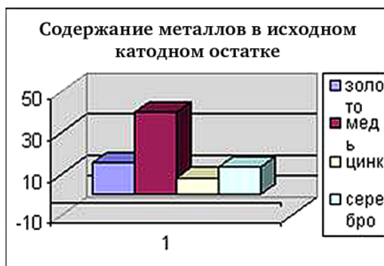
Рис. 3. Содержание примесей в исходном катодном осадке
