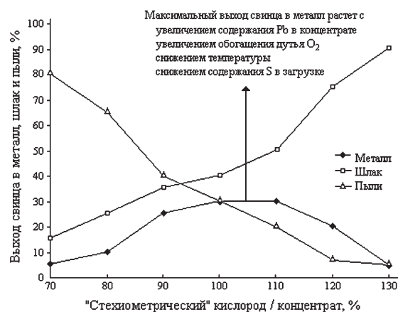
Рис. 1. Распределение свинца по продуктам плавки 50 % Pb концентрата в печи Ausmelt [3]
