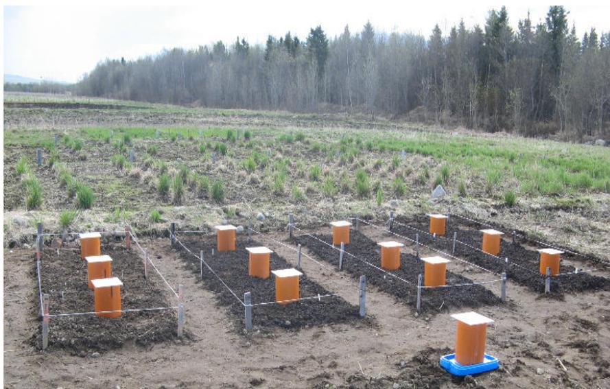
Рисунок 1 – Опытные делянки с сосудами для определения эмиссии почвой углекислоты камерным статическим методом
