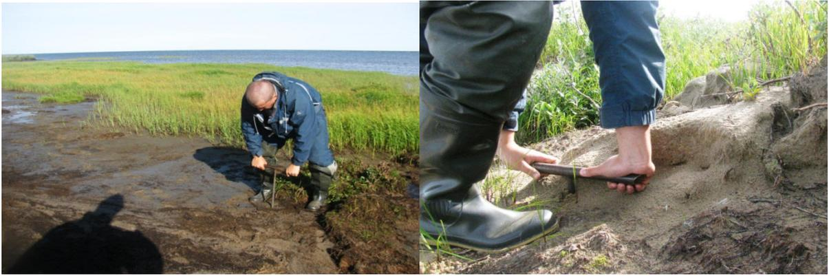
Рисунок 4, 5 – Исследование сезонного протаивания грунтов на Ямале
