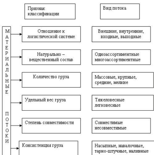
Рисунок 2 – Классификация материальных потоков
