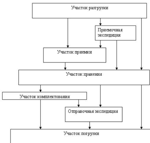
Рисунок 1 – Принципиальная схема материального потока на складе предприятия оптовой торговли
