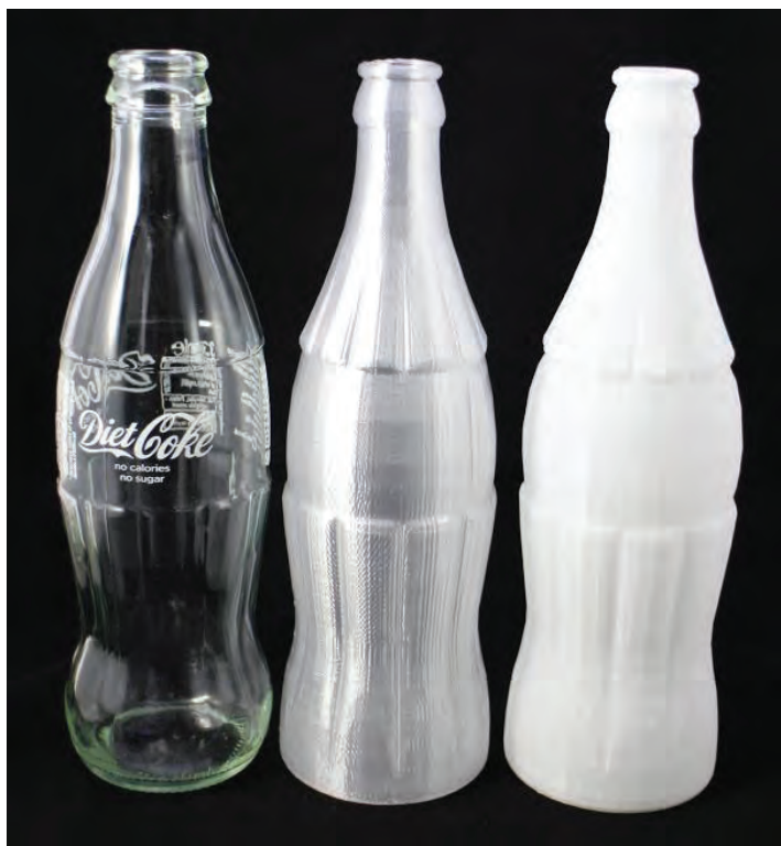
Рис.2. Пример использования пластиковых отходов: 1) Стеклоянная, 2) Напечатана на ПЭТ, 3) Напечатана на белом PLA.
