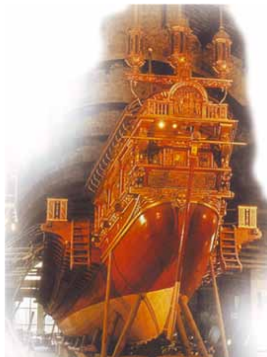
Рис. 9. Галера «Дон Хуан Австрийский»: длина – свыше 55 м, длина палубы – 52 м, ширина – 8,4 м. Высота грот-мачты – 22 м, фок-мачты – 15 м, два косых «латинских» паруса по 56 и 12 м 2 . Экипаж около 400 человек, в т.ч. 286 гребцов, работавших 59 вёслами длиной 11,4 м и весом 180 кг каждое.
