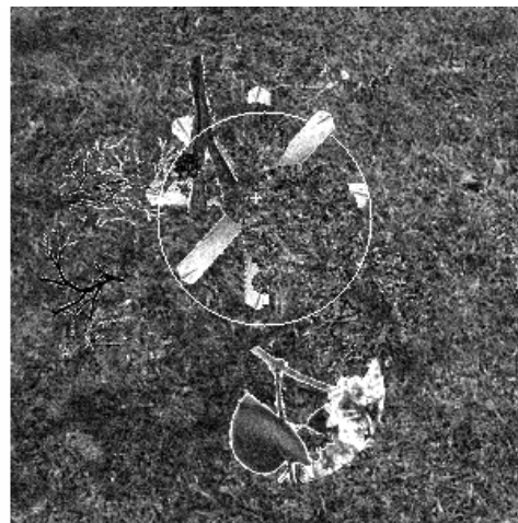
Рис. 1. Слева: объект интереса; справа: пример обнаружения объекта предложенным алгоритмом (белая окружность обозначает найденную локализацию объекта)
