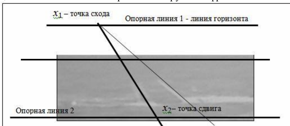
Рис.1. Параметризация ортонормального преобразования Хафа ( x_1 , x_2 )
