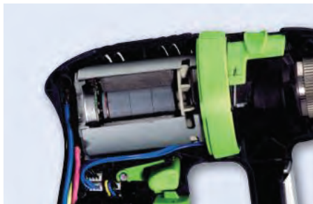
Рисунок 3 – вентильный двигатель аккумуляторного шуруповерта Festool C12
