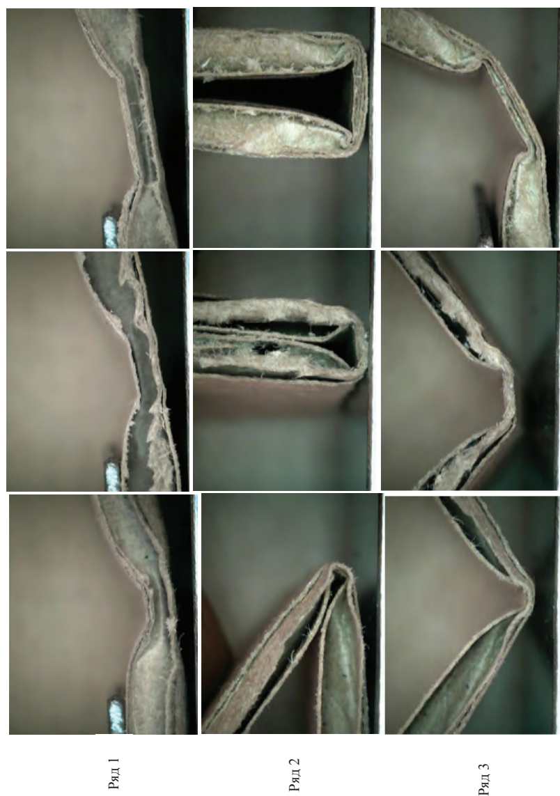
Рис. 3. Фотографии сечения образцов при размере биговочного инструмента В: а) 2 мм., б) 4 мм., в) 6 мм.
