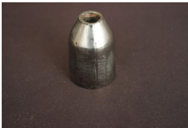
Рис.4. Внешний вид изношенного керна
