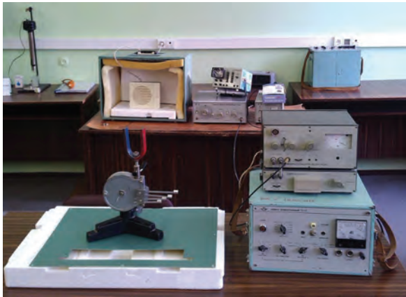
Рис 2. Общий вид стенда для измерения шумовых характеристик опытных образцов.
