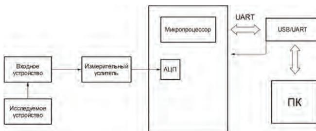
Рис. 1. Структурная схема системы сбора данных.
