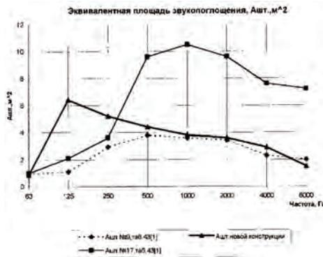
Рис.1. Расчетные значения эквивалентных площадей звукопоглощения штучных звукопоглотителей ( $A_{шт}$ ).
