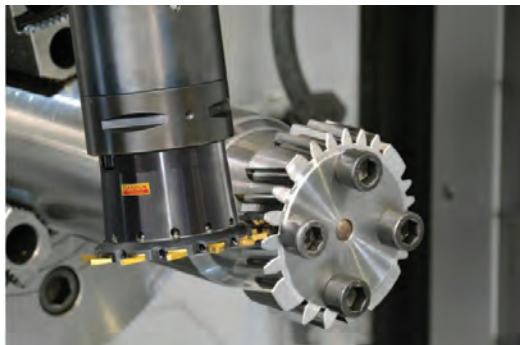
Рис. 1. Процесс нарезания зубчатых колес InvoMilling для изготовления косозубых зубчатых колес
