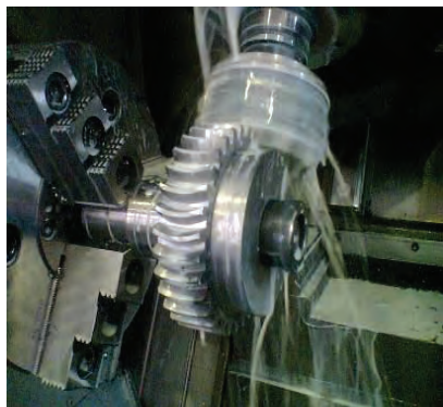
Рис.2 Нарезание колеса на токарном обрабатывающем центре
