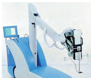
Рисунок 4 - Рабочая модель медицинского аппарата на базе Nonapod
