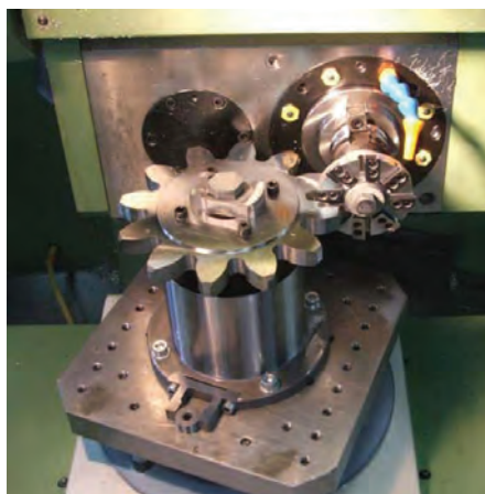
Рис. 4. Обработка крупномодульных зубчатых колес по методике, изложенной в работе [3]
