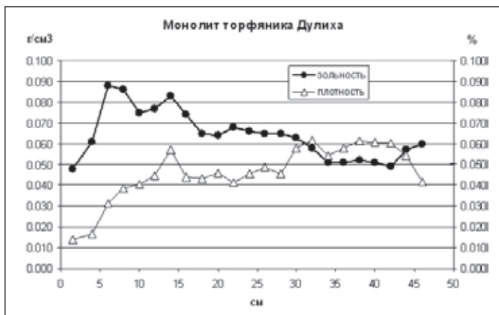
Рис. 1. Графики плотности сухого торфа ( \text{г/см}^3 ) и его зольности (%) в монолите торфяника Дулиха
