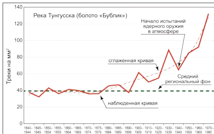
Рис. 2. Изменение глобального фона делящихся альфа-излучающих радионуклидов ( ^{235}\text{U} , Pu, Am и др.) за последние 150 лет по данным осколочной (f) радиографии
