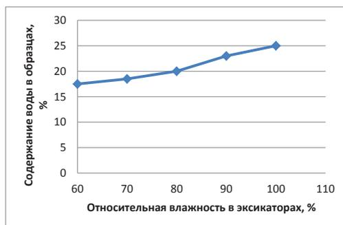
Рис. 2. Изотерма сорбции воды образцами эковаты в условиях влажности воздуха в диапазоне от 60 до 100 % .
