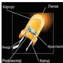
Рисунок 1.1 – Строение светодиода
