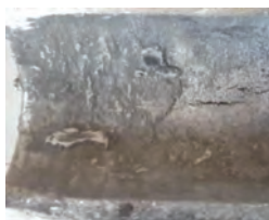
Рис. 4. Продольная трещина на внутренней поверхности отливки, полученной при температуре прогрева формы t_{form} = 120\text{ }^{\circ}\text{C}
