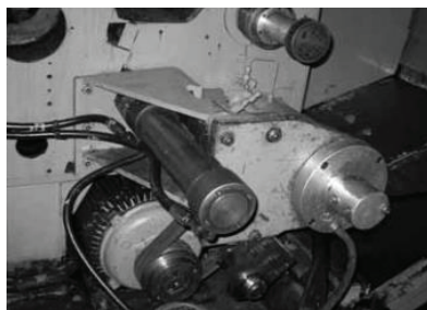
Рисунок 4 Внешний вид системы переключения скоростей привода главного шпинделя после модернизации
