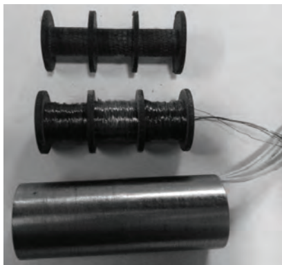
Рисунок 2 Конструкция датчика перемещения (каркас, каркас с обмотками, датчик в сборе)
