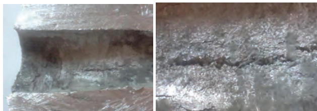
Рис. 2. Продольная трещина на внутренней поверхности отливки, полученной при температуре прогрева формы t_{form} = 80^\circ\text{C}
