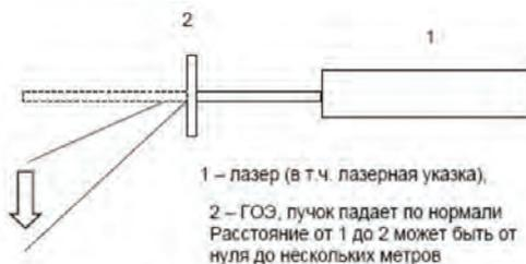
Рис.3. Макет лазерного указателя
