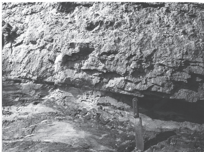
Рис. 12. Экзарационный контакт печорского тилла плитчатой текстуры с развальцованными, растащенными, перетертыми плотными подстилающими песками и супесями с включениями моренного материала (обн. 16, р. Лая)
