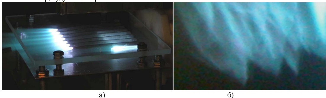
Рис. 5. Устойчивое горение пропана в сверхзвуковом потоке (а). Фронт горения (б) совпадает с линиями распространения возмущений в сверхзвуковом потоке с M=2
