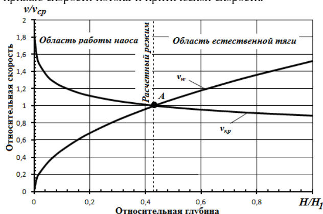
Рис. 2. Области эксплуатации добычного комплекса
