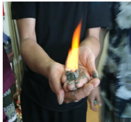
Рис.4. В руках горит метан, выделяется из газогидрата
