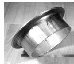
Рис. 4. Раскатанный фланец из трубной заготовки диаметром 219,1 мм: толщина стенки 7,8 мм, толщина фланца 9,4мм, ширина фланца 38..39 мм, радиус перехода от трубной части к фланцевой  $R=12,7$  мм, материал AISI 316 значительной механической обработке по торцевой и боковой поверхностям фланцевой части. Коэффициент использования металла при представленной технологии раскатки с многостадийной осадкой составляет около 95%.
