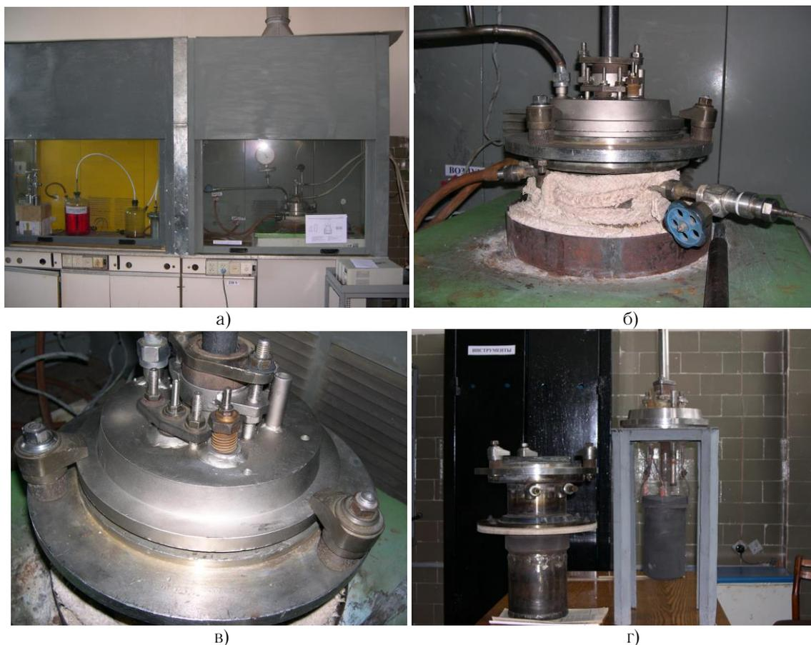
Рис. 2. Опытная электролитическая установка электролитического разложения тетрафторида титана.
