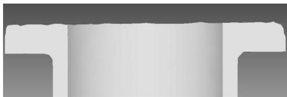
Рис. 3. Моделирование конечной стадии формообразования фланца при раскатке с многостадийной осадкой трубной заготовки
