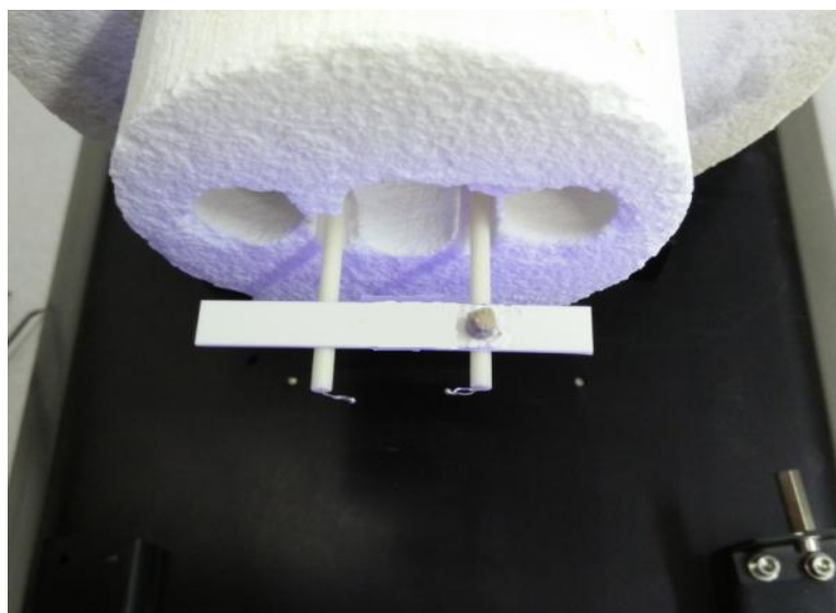
Рис 5. Вид расположения образца при проведении ДТА
