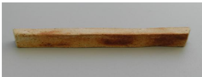
Рис.1. Вид образца из композиционного материала на химической связке после испытания в температурном интервале до 1500 °С
