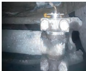
Рис. 3 Выход пальца из проушин
