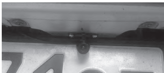
Рисунок 1. Место крепления камеры на заднем бампере
