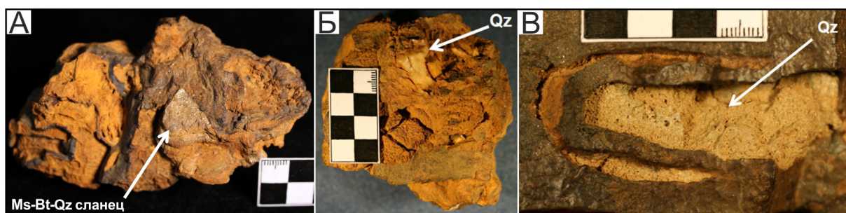
Рис. 8. Реликты сланцев (а) и кварца (б и в) в гётитовой массе.
