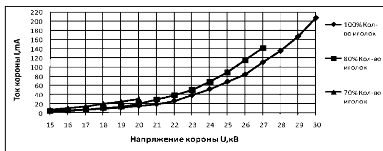
Рис. 1. Вольтамперные характеристики установки в зависимости от количества коронирующих иглолов (электродов)[2]
