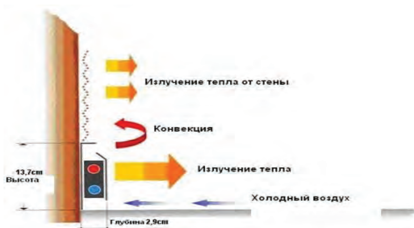
Рис.1 - Принцип действия системы отопления теплый плинтус
