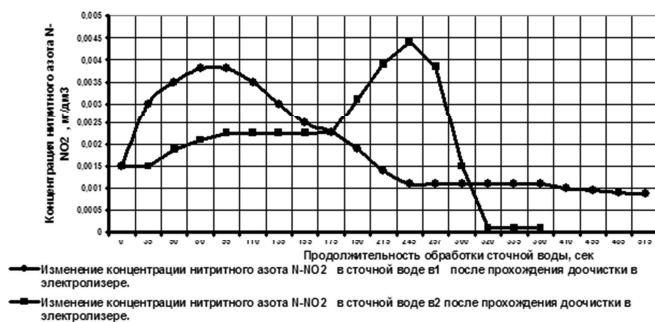
Рис. 1. Изменение концентрации нитритного азота N-NO 2 - после прохождения доочистки в электролизере.
