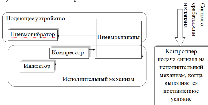
Рисунок 2. Структурная схема исполнительного блока экспериментальной установки 3D сканирования.
