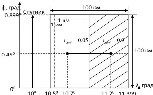
Рис. 2. – Взаимное расположение спутника и наблюдаемой области, а также распределение коэффициента отражения по земной поверхности
