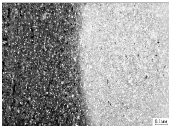
Рис. 2. Граница между исходной коричневой и осветленной породой; шлиф, без анализатора
