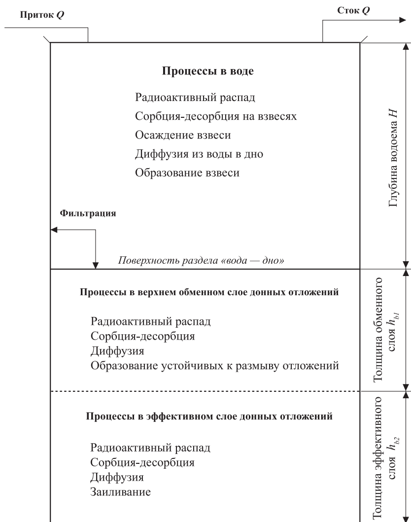
Рис. 3.5. Схема учитываемых в трехкамерной модели процессов миграции радионуклидов
