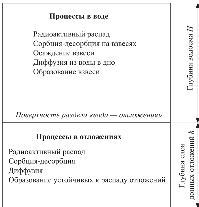
Рис. 3.4. Схема учитываемых в двухкамерной модели процессов миграции радионуклидов
