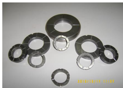
Рис. 2 Торцовые уплотнения нового поколения из композиционного материала на основе карбида кремния (слева) и торцовые подшипники скольжения нового поколения с управляемым коэффициентом трения из композиционного материала на основе карбида кремния (справа)
