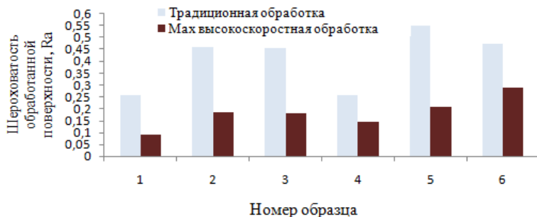
Рисунок 2 - Гистограмма изменения шероховатости поверхности образцов стали 30ХГСА в зависимости от режимов термической обработки и режимов резания
