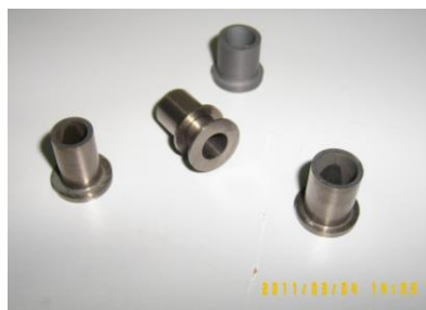
Рис. 5 Радиально-упорные подшипники скольжения для поворотных лопаток газотурбинного двигателя из высокотемпературного композиционного материала на основе карбонитрида титана
