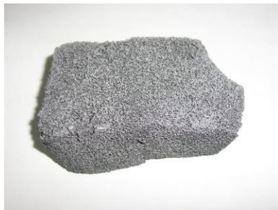
Рис. 4 Композиционный высокотемпературный сотовый карбид кремния для рассеивания и отражения тепловых потоков.
