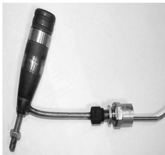
Рис.2. Схема модели РД с зарядом твердого или пастообразного топлива на тензометрических весах и фотография модели с датчиком давления ДМП-60.
