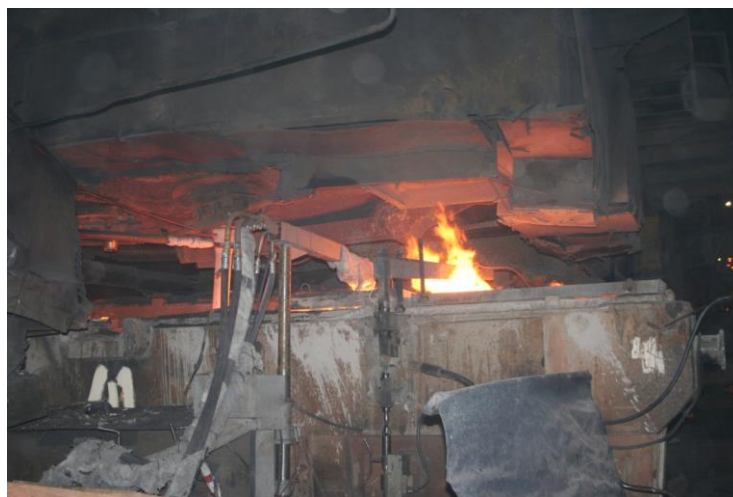
Рис.8. Консоль с плазмотроном в рабочем положении.
