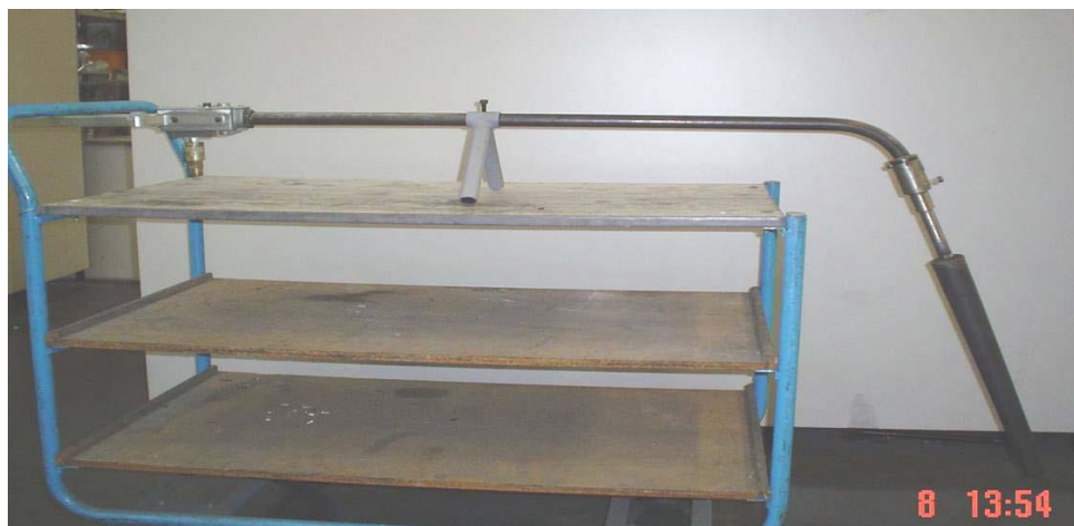
Рис.10. Погружной жезл системы Contilance.
