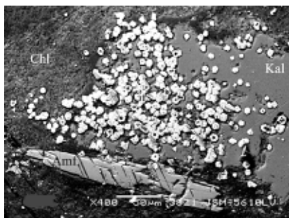
Рис. 2. Электронно-микроскопическое изображение фрагмента лампроита-керсантита с многочисленными ромбо-додрачическими кристалликами граната гроссуляра проба 38/180 (Grs — гроссуляр, Kal — кальцит, Amf — роговая обманка, Chl — хлорит)
