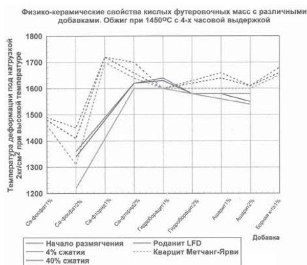
Рис. 2. Влияние различных добавок на температуру деформации под нагрузкой футеровочных масс, приготовленных из шведского и карельского кварцита
