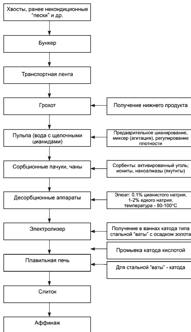
Рис. 4. «Рудная схема» обработки россыпей
